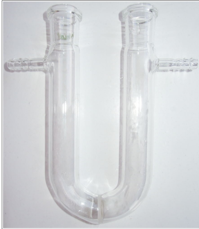
Ein U-Rohr mit Diaphragma
