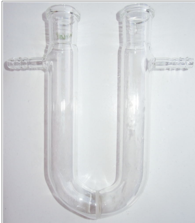
Ein U-Rohr mit Diaphragma
